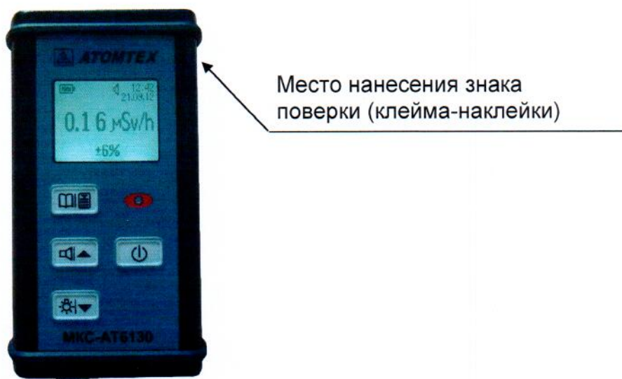
Рисунок 2 – Место нанесения знака поверки (клейма-наклейки)
