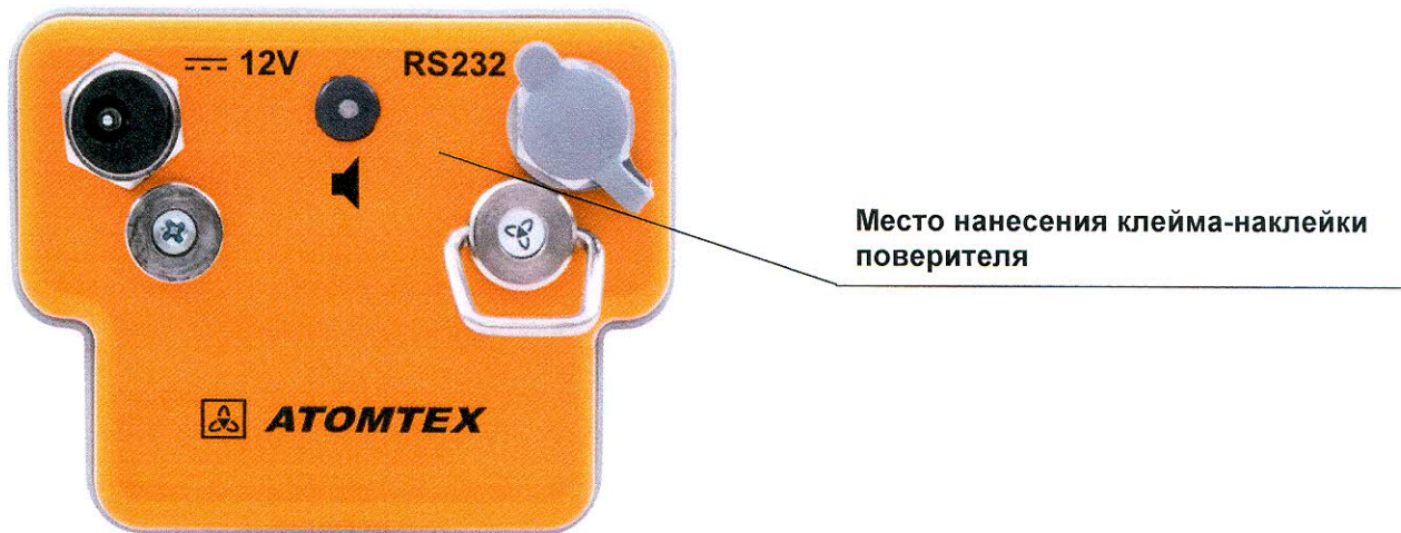
Рисунок 2 – Место нанесения знака поверки (клейма-наклейки) на дозиметр
