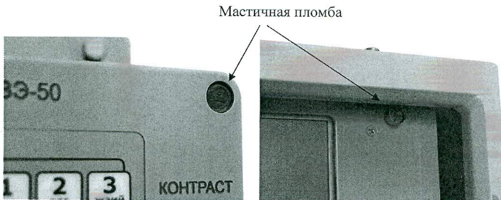
Рисунок 3 – Схема пломбировки прибора ИВЭ-50 от несанкционированного доступа
