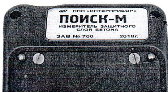
Рисунок 1 - Место нанесения пломбировки от несанкционированного доступа на панели электронного блока приборов ПОИСК-М
