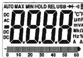
\*F °C,  $\mu$ nF, mVA, M $\Omega$ , Hz%, A Единицы измерений температуры, ёмкости, напряжения и силы переменного тока, сопротивления, частоты, коэффициента заполнения, силы постоянного тока
