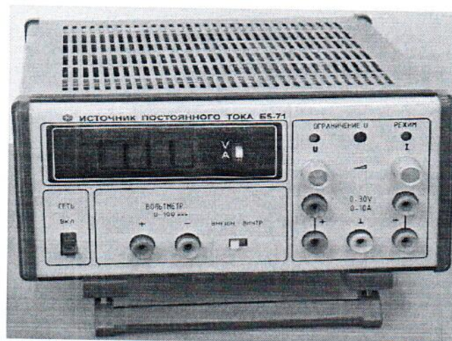
Рис. 1 – Источник постоянного тока Б5-71
