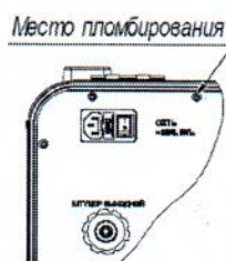
Рис. 2 – Схема пломбировки от несанкционированного доступа калибратора «ЭЛЕМЕР ПКД-160-П»
