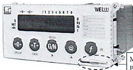
Пломбировка доступа к переключателю режимов настройки и юстировки на передней панели корпуса приборов модификаций WE2111
