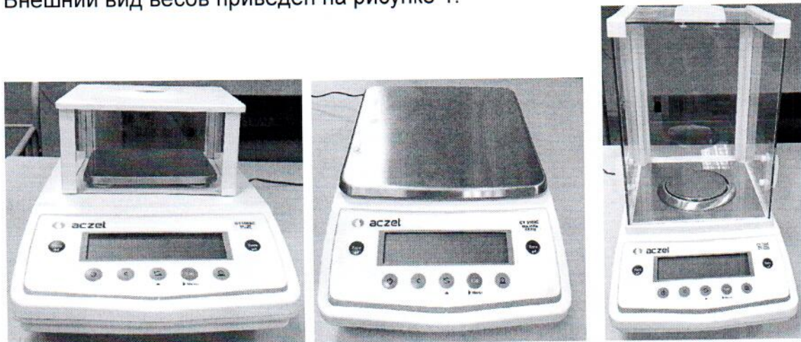
Рисунок 1 – Общий вид весов неавтоматического действия серии SY.
