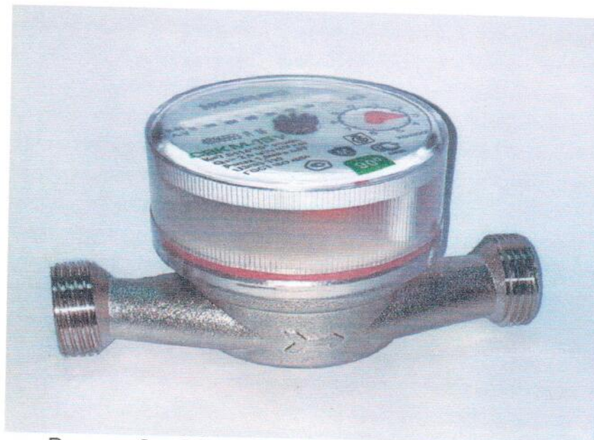
Рисунок 2 – Общий вид счетчиков СВКМ DN 15, имеющих специальное крепление счётного механизма к корпусу без кольца (снятие крышки невозможно без ее механического повреждения)
