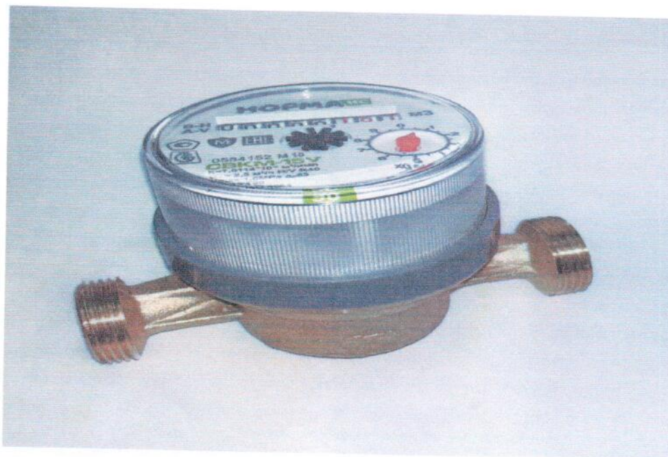
Рисунок 1 – Общий вид счетчиков СВКМ DN 15, имеющих специальное крепление счётного механизма к корпусу с помощью неразъемного кольца (снятие кольца невозможно без его механического повреждения)
