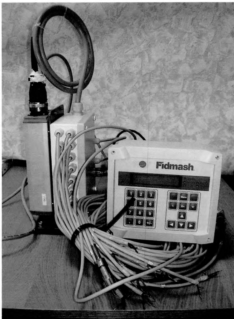
Рисунок 1 - Внешний вид комплекса измерительно-регистрающего СКР43-10.
