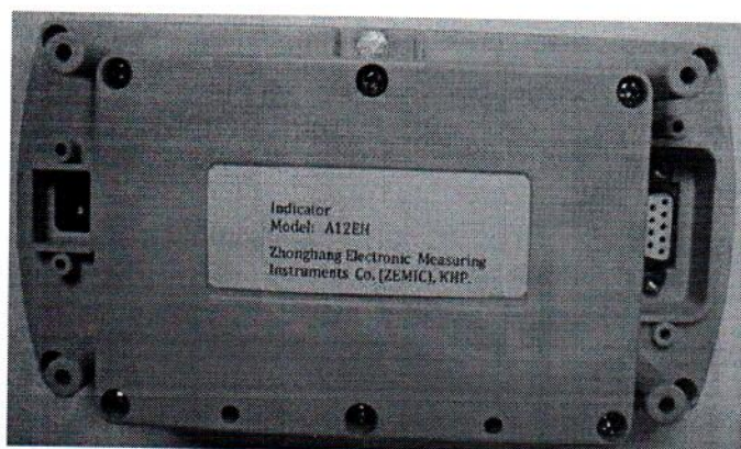
Рисунок А2 – Место пломбирования весового индикатора ZEMIC A12EH (пломба на задней панели в углублении корпуса для винта)
