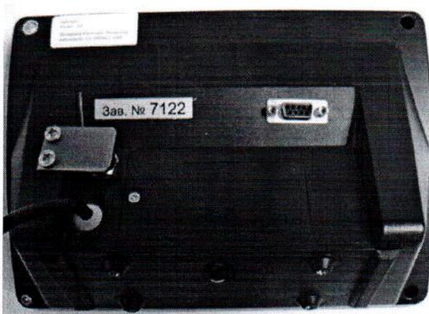
Рисунок А6 – Место пломбирования весового индикатора ZEMIC A6 (пломба на задней панели в углублении корпуса для винта )
