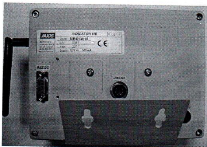
Рисунок А3 – Место пломбирования весового индикатора AXIS ME-01/A18 (пломба на задней панели в углублении корпуса для винта)
