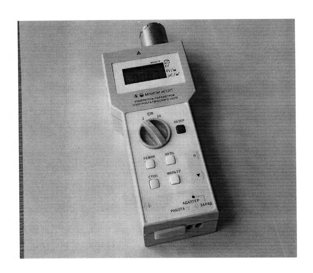
Рисунок 1-Внешний вид измерителя
