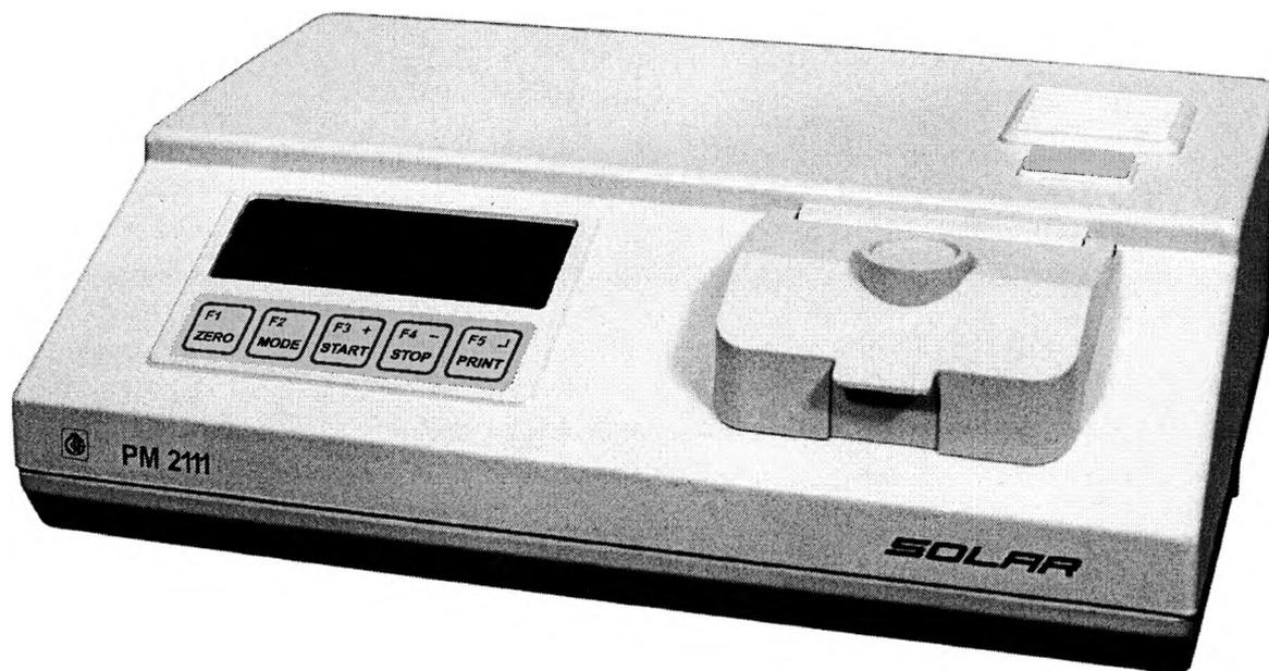
Рисунок 1 – Внешний вид фотометра РМ 2111
