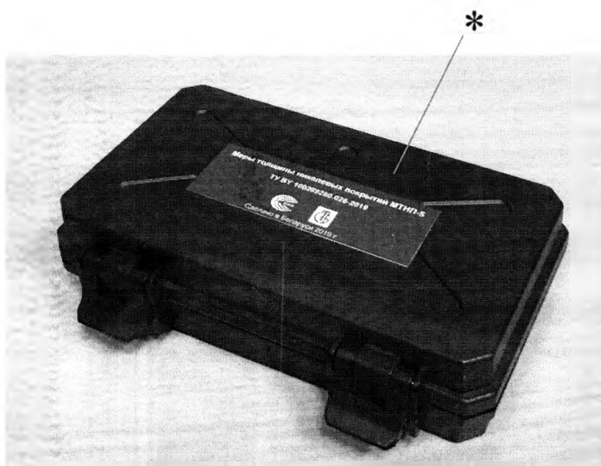
Рисунок А.1 – Меры толщины никелевых покрытий МТНП-5 (* – место нанесения знака поверки в виде клейма-наклейки)
