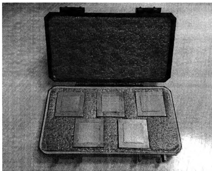
Рисунок 1 – Внешний вид мер толщины никелевых покрытий МТНП-5
