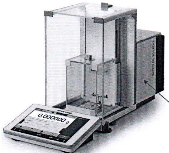
Рисунок 1а – Общий вид весов с действительной ценой деления d=0,001 \text{ мг} ; Условное обозначение взвешивающего модуля 26, 56
