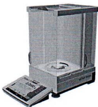
Рисунок 1в – Общий вид весов с действительной ценой деления d=0,1 мг. Условное обозначение взвешивающего модуля: 204S, 404S, 504S
