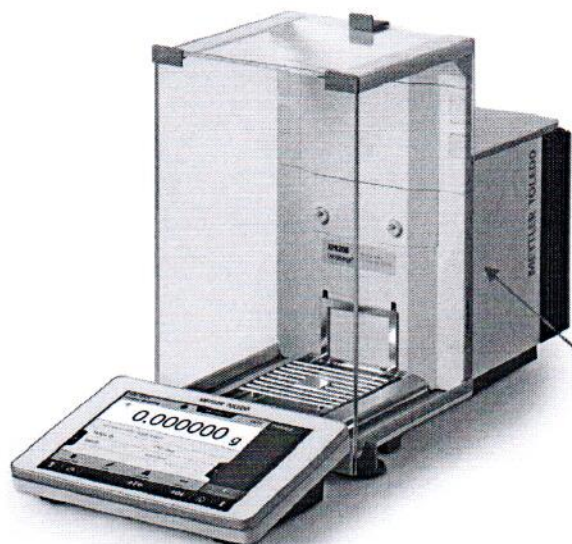
Рисунок 1б – Общий вид весов с действительной ценой деления d=0,01 и 0,1 мг. Условное обозначение взвешивающего модуля 206, 105, 205, 225, 305, 505, 64, 104, 204, 304
