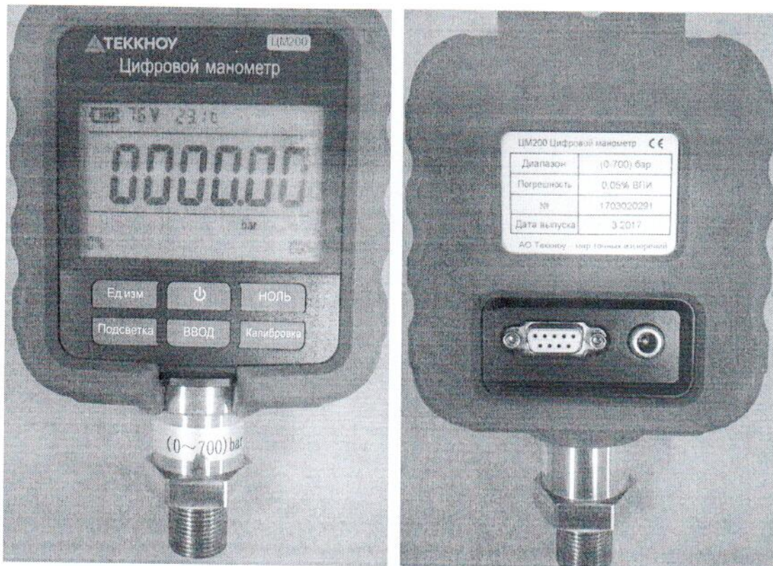
Рисунок 2 – Внешний вид манометра цифрового серии ЦМ200
