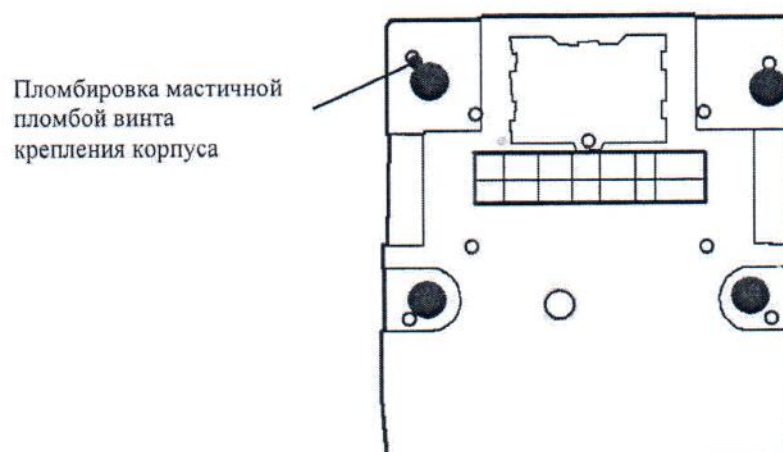
Рисунок 3 - Схема пломбировки весов ВСП-1, ВСП-2, ВСП-3, ВСП-4 от несанкционированного доступа
