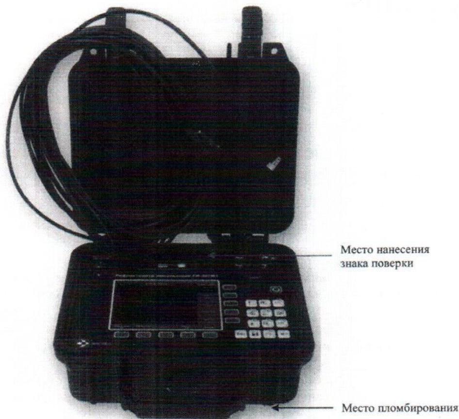
Рисунок 1 – Общий вид рефлектометров импульсных РИ-307М3
