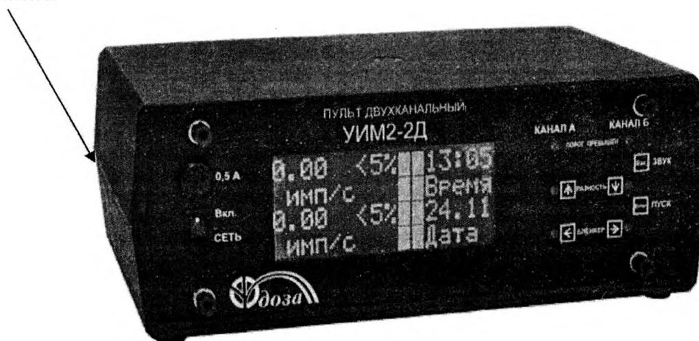
Рисунок 2 - Пульт измерительный двухканальный УИМ2-2Д
