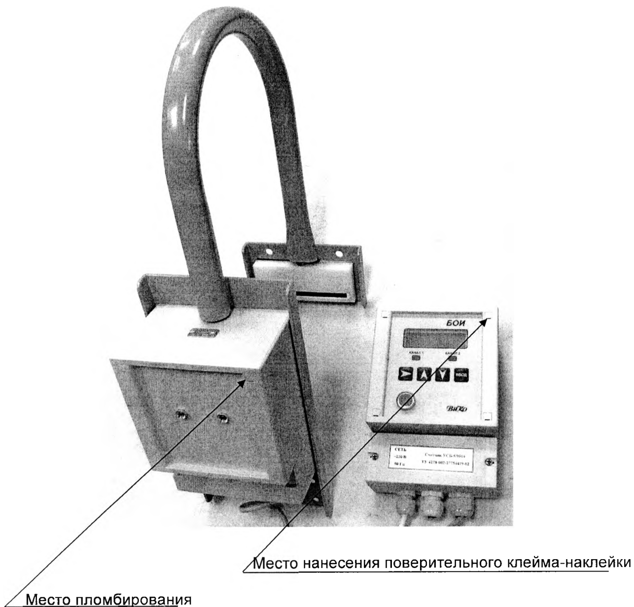
Рисунок А.1 – Схема с указанием мест нанесения поверительного клейма-наклейки и пломбировки
