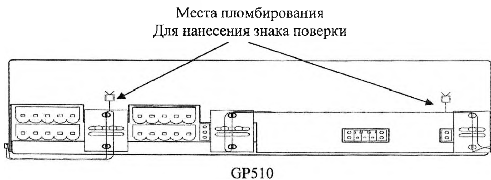
Рисунок 4 - Схемы пломбирования защитной крышки тумблера «Настройка/работа» отсчетного устройства БИУ
