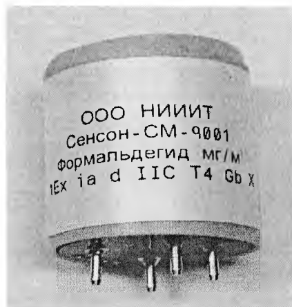
Рисунок 7 - Общий вид исполнения СМ (измерительный интеллектуальный модуль)
