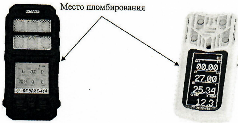
Рисунок 3- Фото общего вида газоанализатора ПГ ЭРИС-414-1 с указанием нанесения места пломбирования
