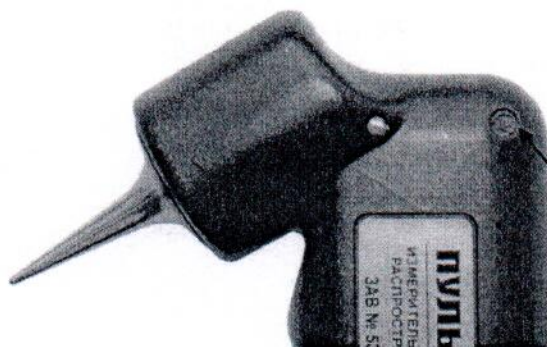
Рисунок 2 - Место нанесения пломбировки от несанкционированного доступа на панели электронного блока прибора модификации ПУЛЬСАР-2М
