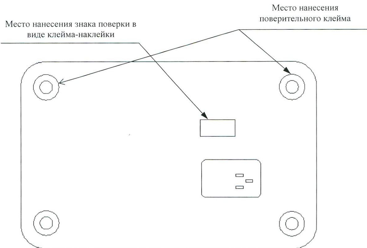
Рисунок А.1 – Места нанесения поверительного клейма и знака поверки в виде клейма-наклейки (вид осциллографа сзади)
