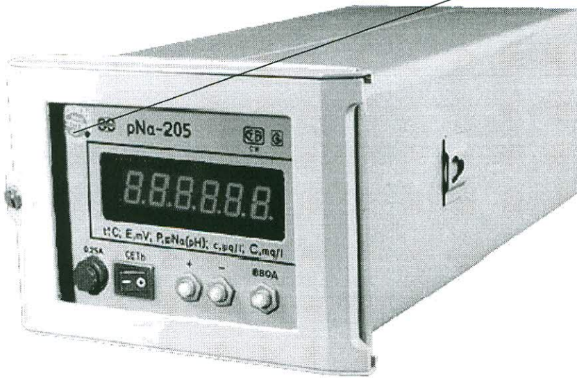
Рисунок А.1 - Схема нанесения на анализатор знака поверки
