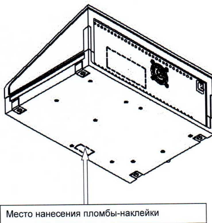
Рисунок А.1 – Схема нанесения знака поверки прибора
