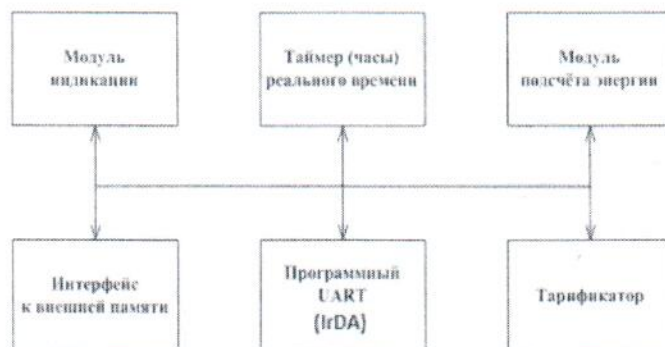
Рисунок 4 - Структура программного обеспечения «Меркурий 202»
