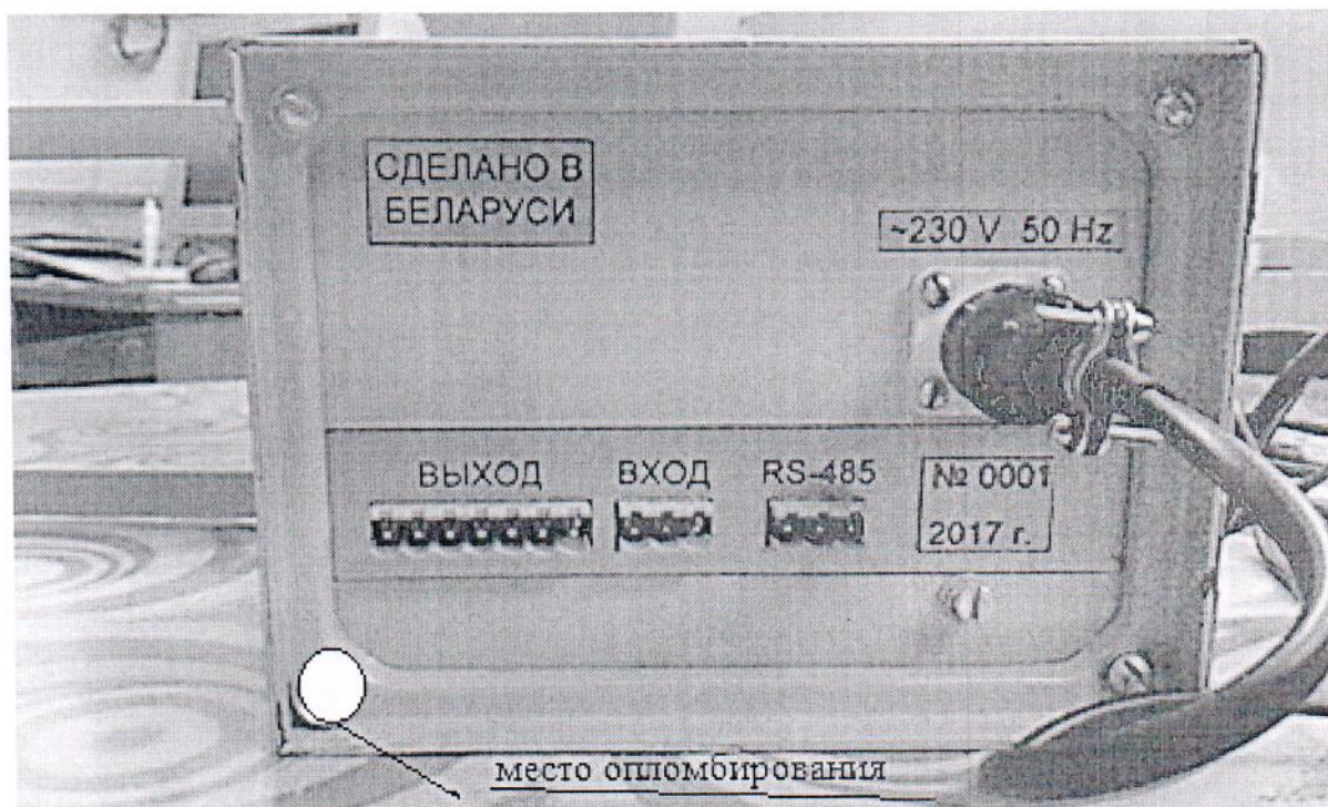
Рисунок А.2 – Схема опломбирования тахометра от несанкционированного доступа
