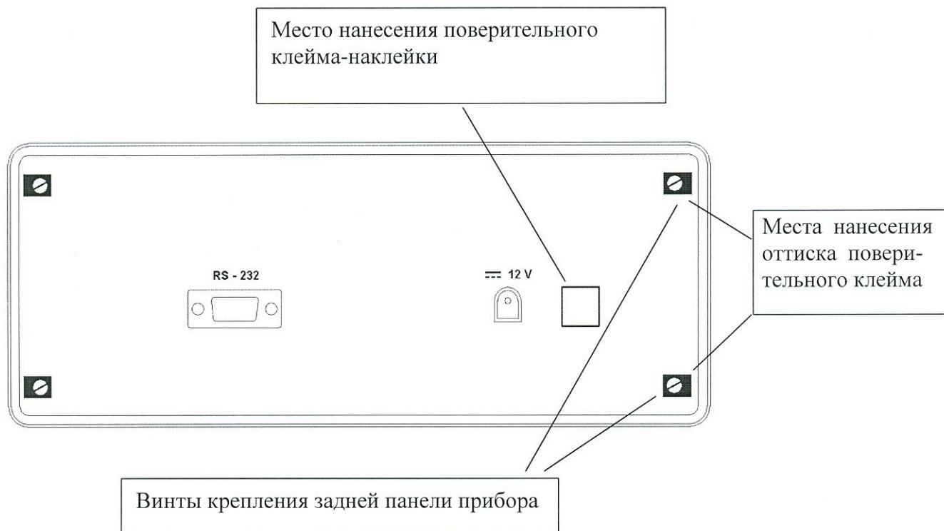
Рисунок А.1. Схема пломбирования на задней панели шумомера-анализатора
