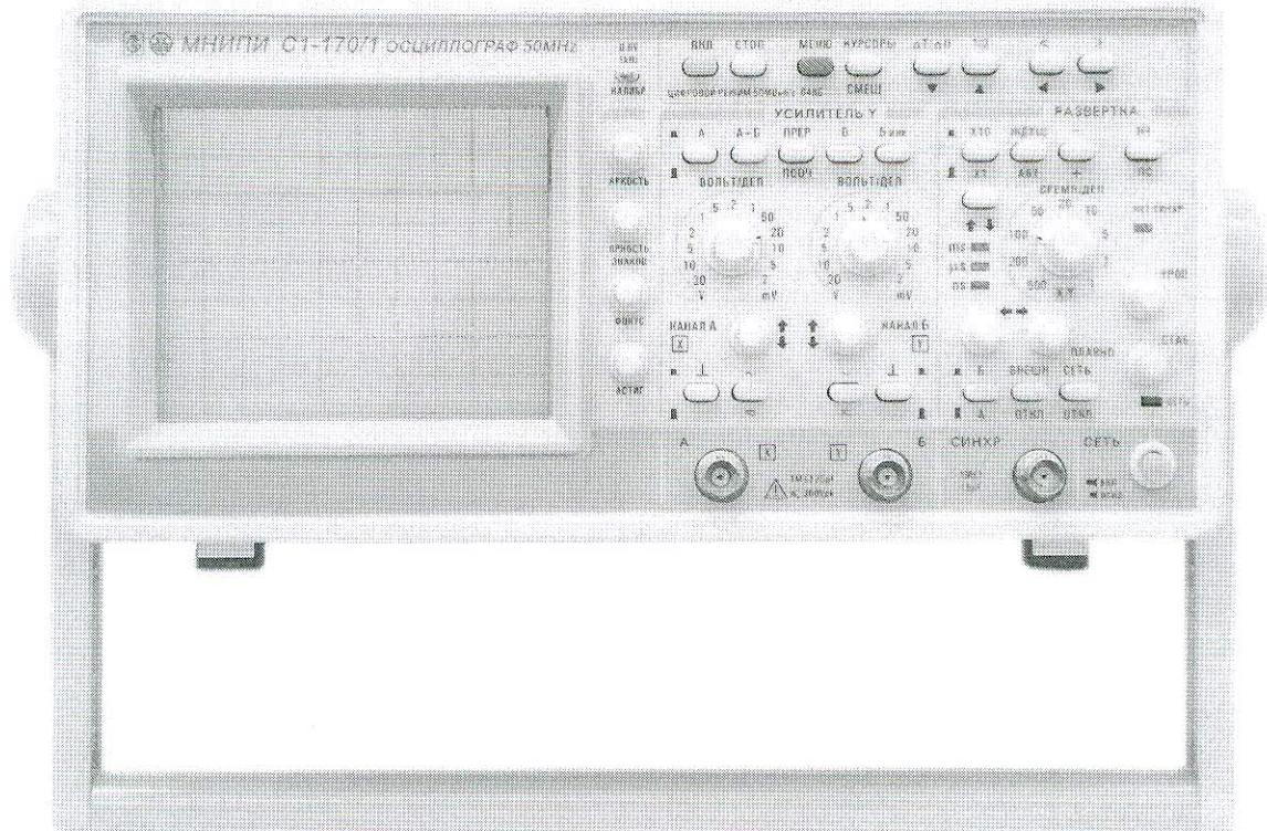
Рисунок 2. Внешний вид осциллографа С1-170/1
