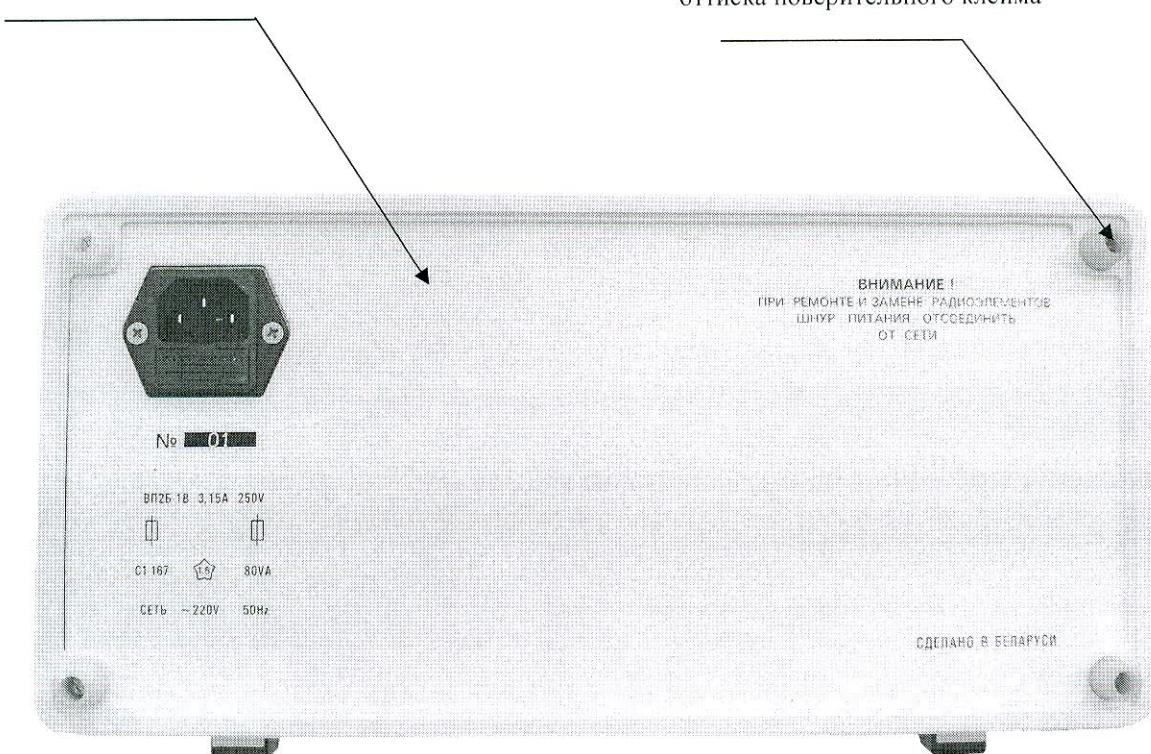
Рисунок 4 - Задняя панель осциллографов С1-170, С1-170/1, С1-170/2
