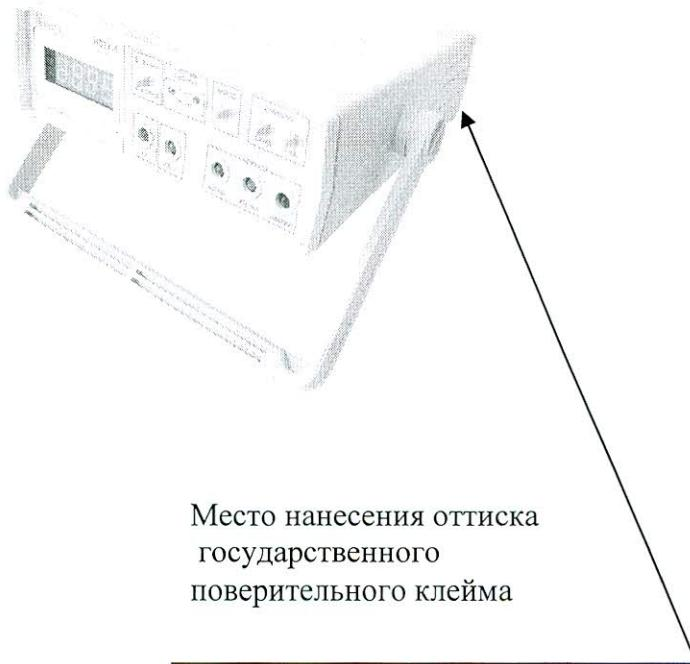
Рисунок А.1 – Место нанесения оттиска государственного поверительного клейма
