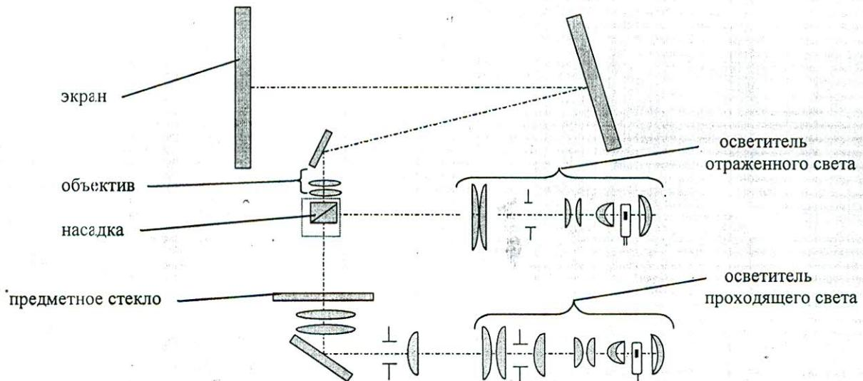
Лучи от лампы осветителя проходящего света освещают деталь, а затем объектив проецирует теневое изображение детали на экран.
