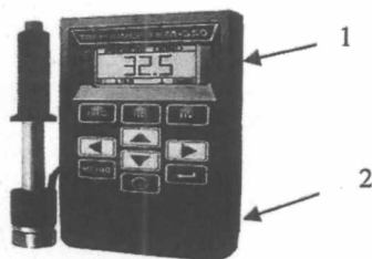
Рисунок 3. - схема пломбировки модификации ТКМ-359М 1,2-места пломбировки
