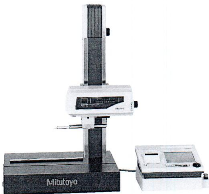
Рисунок 9 – Внешний вид приборов для измерения параметров шероховатости Surftest SJ-500P
