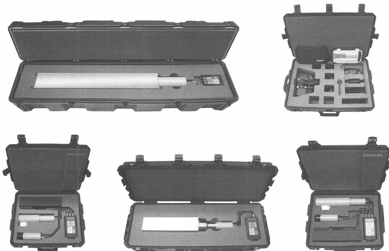
Рисунок 1 – Общий вид основных измерителей комплекса МКС-АТ6103
