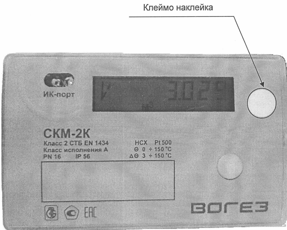
Рис. 2 Схема нанесения знака поверки в виде клейма – наклейки на переднюю панель вычислителя.
