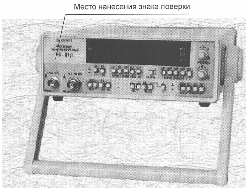
Рисунок А.2 – Место нанесения знака поверки (лицевая панель частотомера)
