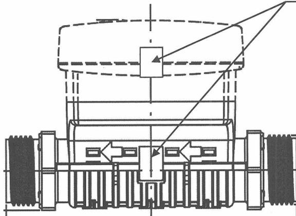
Рисунок А.1– Места клеймения и пломбирования теплосчетчиков Ф-Прибор T230
