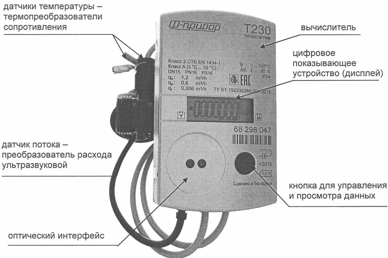
Рисунок 1 – Внешний вид теплосчетчика Ф-Прибор T230
