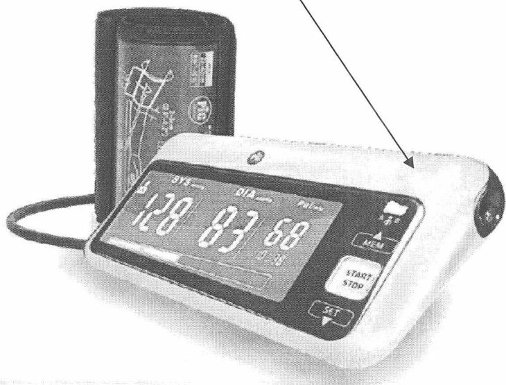
Рисунок А.1 – Место нанесения знака поверки (клейма-наклейки)
