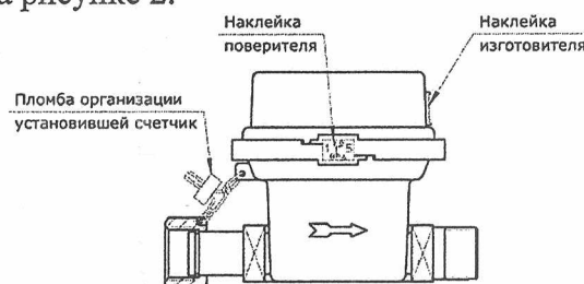
Рисунок 2 – Схема пломбировки счетчиков
