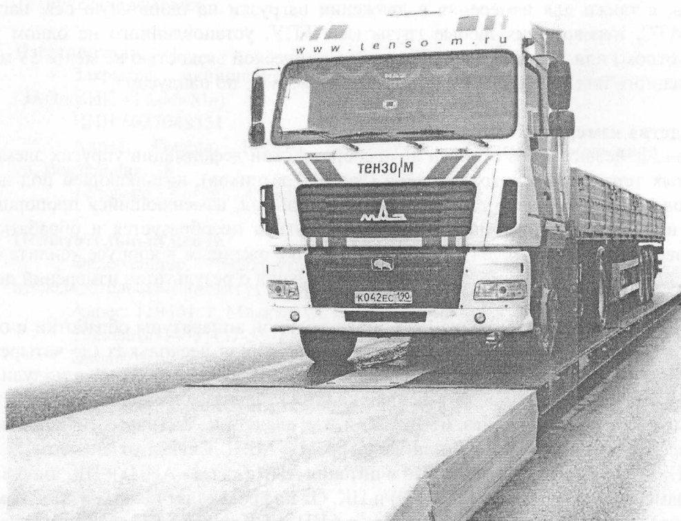
Рисунок 1 – Внешний вид весов «АВИОН» с ГПУ, выполненной над дорожным полотном, с заездом по наклонным пандусам..
