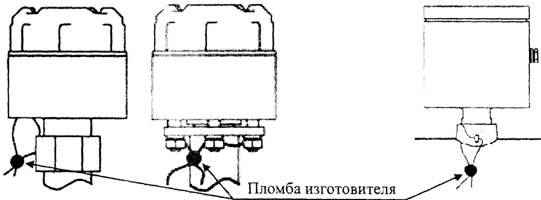
Рисунок 17 – Схема пломбировки ВП ЛУЧ-01 и ЛУЧ-02
