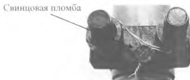
Рисунок 5 – Схема пломбировки датчика
