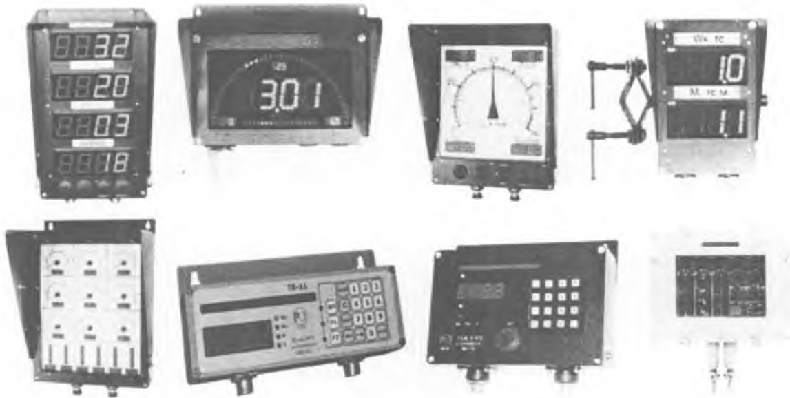
Рисунок 3 – Общий вид дублирующих показывающих устройств
