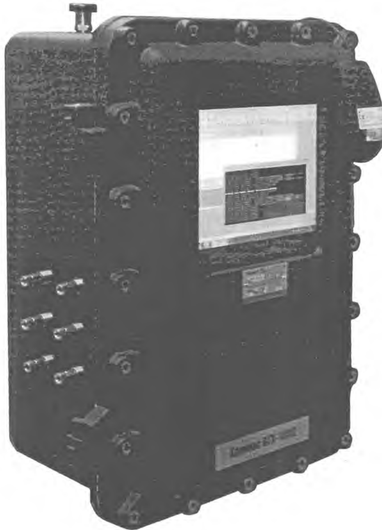
Рисунок 1 - Внешний вид хроматографа газового промышленного специализированного «Хромос ПГХ-1000»
