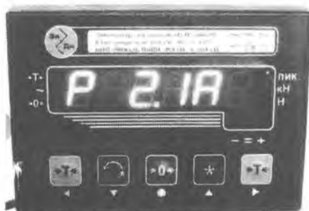
Рисунок 1. Внешний вид электронного блока с изображением версии программного обеспечения.
