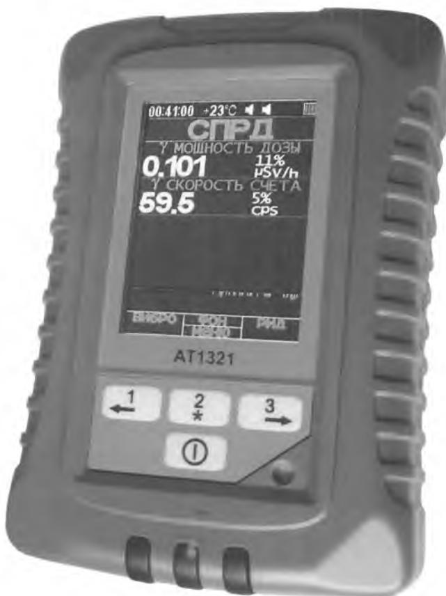
Рисунок 1 – Общий вид спектрометра МКГ-АТ1321
