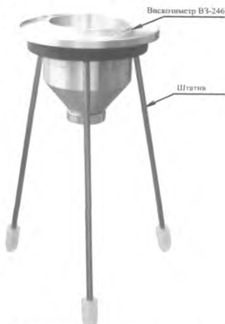
Рисунок 1 – Внешний вид вискозиметра для определения условной вязкости лакокрасочных материалов ВЗ-246
