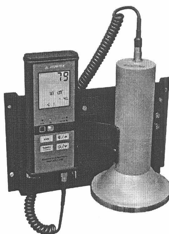
Рисунок 3 - Дозиметр-радиометр МКС-АТ117М в составе с БДПБ-02 и БОИ2 в варианте размещения на вертикальной поверхности
