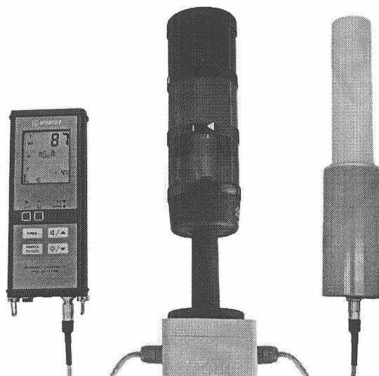
Рисунок 5 - Дозиметр-радиометр МКС-АТ1117М в составе с БДКГ-01, УС и БОИ2
